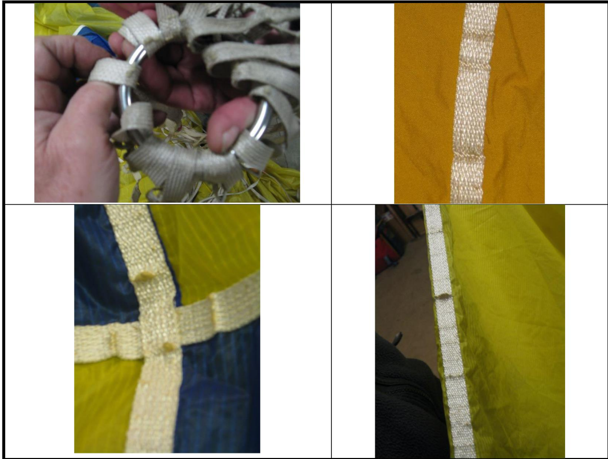
Figure 1 : exemple de dommage du ruban de charge
